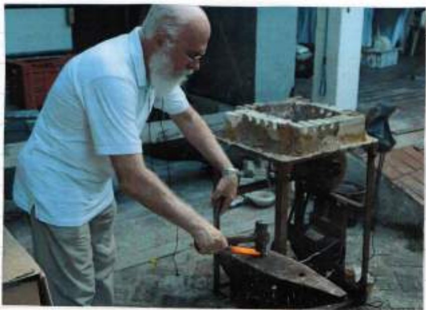
Tinoco ma- lhando ferro à quente
